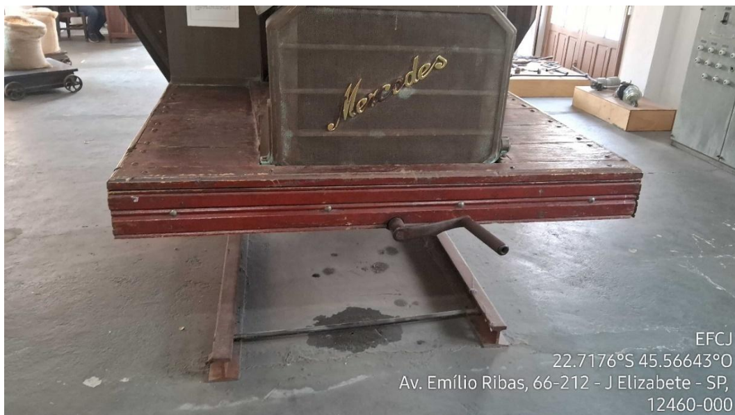
Figura 16 - Locomotiva de acervo histórico com vazamento de óleo - Centro de Memória Ferroviária de Campos do Jordão
