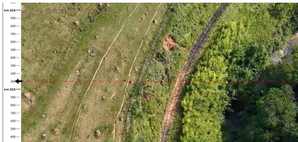
Figura 42 - Imagem aérea de drone - Erosão laminar em talude adjacente
