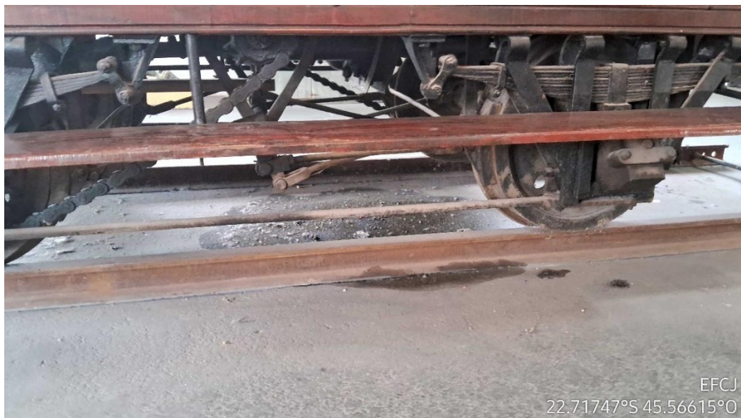
Figura 16 - Locomotiva de acervo histórico com vazamento de óleo - Centro de Memória Ferroviária de Campos do Jordão
