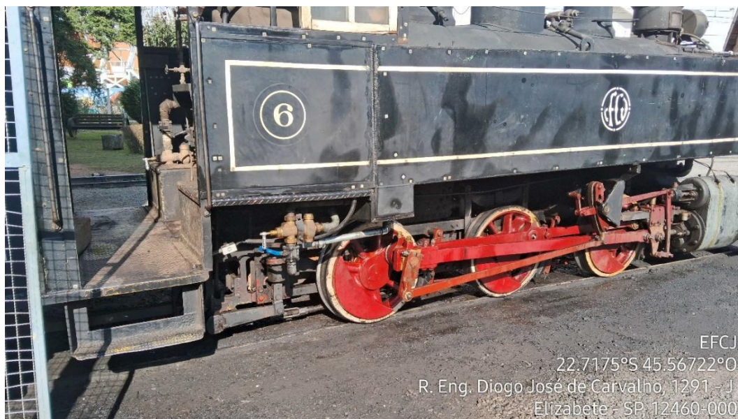
Figura 21 - Detalhe da locomotiva com vazamentos - Pátio de Manutenção Capivari (2024)
