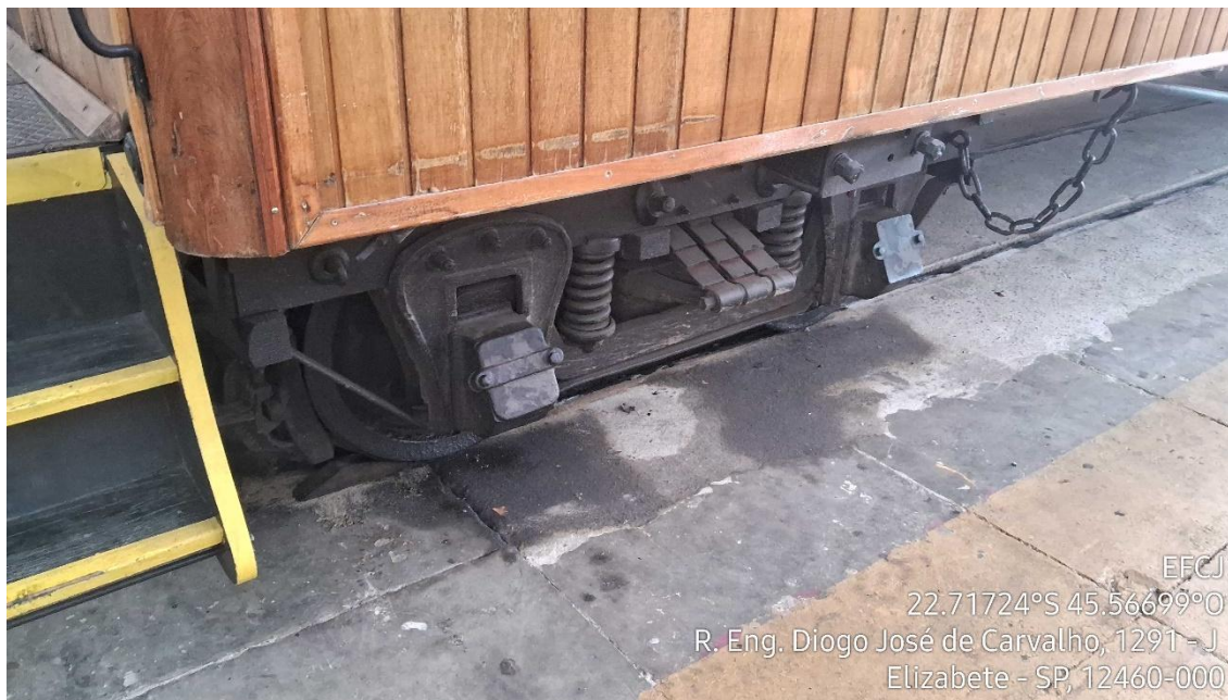
Figura 27 - Manchas de vazamento de óleo provindos de truck do vagão de passageiros, por sobre piso com trincas - Pátio de Manutenção Capivari
